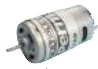
Moteur Permax 480 Tension 7,2V. 17 000 t/min. ø 27,7mm. Longueur 51 mm. Poids 92g. Axe moteur ø 2,3 mm Réf : 005 33 2689
