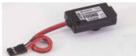
Appareil permettant de localiser un modèle. Il se connecte entre servo le récepteur, comme une rallonge. 40 x 21 8,5 mm. Poids 9g. Câblé Graupner. Réf : 002 3161
