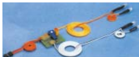
Centrale clignotante de positions Elle se compose d'un circuit électronique, de trois diodes rouges et d'une diode verte. Le système dispose de deux vitesses de clignotement. 36 x 28 x 13 mm, poids 21g, tension 4,8 à 6V, conso moyenne 33mA. Réf : 002 2971
