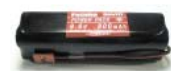
Accu émission 9,6V 800mA pour radio FF8. Temps de charge 14 heures sur la sortie 50 ou 60 mA du chargeur Référence : 004 17 0808
