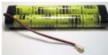
Accu réception 4,8 V 250 mA. Temps de charge 6 heures sur la sortie 50 mA du chargeur. Poids 55 g. Dimension 15 x 30 x 57 mm. Référence : 004 17 0304
