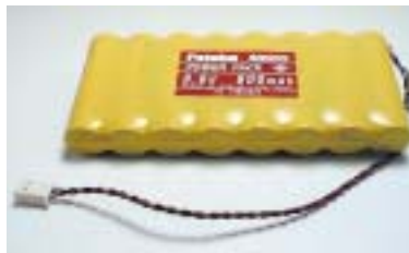
Accu émission 9,6V 600mA pour radio Skysport et FF6. Temps de charge 12 heures sur la sortie 50 ou 60 mA du chargeur. Référence : 004 17 0608
