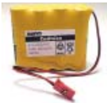
Accu réception 4,8 V 600 mA. Temps de charge 12 heures sur la sortie 50 ou 60 mA du chargeur. Poids 90 g. Dimension 14 x 52 x 57 mm. Référence : 004 17 6041
