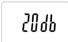
Le chiffre 20 indique la puissance d'émission en dBm de l'émetteur actuellement sélectionnée.
