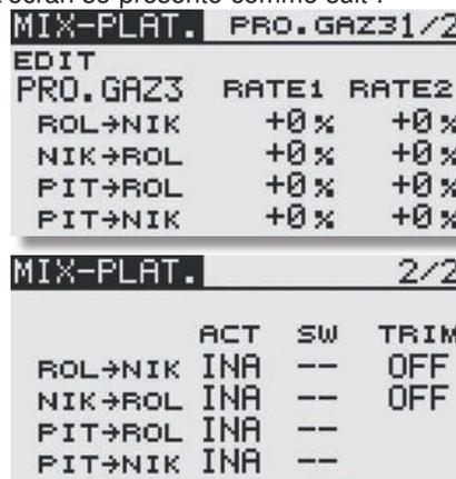
dans le second écran, il faut d'abord activer le dispositif de mixage qu'on souhaite activer 'ACT'. Marquez d'abord la fenêtre, réalisez le réglage avec la rubrique „CAP TOUCH“ et activez en actionnant "RTN". Ensuite dans la fenêtre apparaît la position de l'interrupteur 'MARCHE' ou 'ARRET'.
