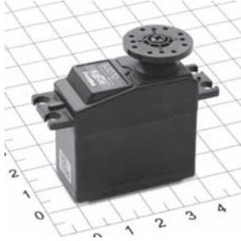
Avec mécanisme en métal sur double roulement à billes, un couple de 65 Ncm à 7,4 volts et le fait d'être programmable, sont les caractéristiques essentielles de ce servo S.BUS.
