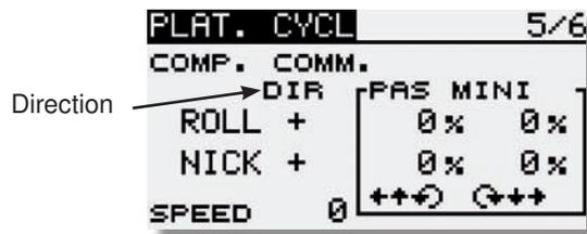
Dans le menu de mise au point du plateau cyclique (5/5) il est également possible de compenser la vitesse (SPEED). Amenez tout d'abord le manche des gaz en position neutre. Déplacez ensuite le manche de tangage autant que possible rapidement. Établir la programmation de la vitesse avec une valeur en % de manière que la fonction de pas n'en souffre pas.
