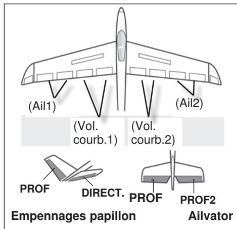
Sur de nombreux modèles, le fait de sortir les volets de courbure comme volets d'atterrissage provoque une modification des charges au voisinage de l'axe transversal.
