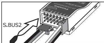
Ne raccordez en aucun cas des appareils S.BUS à S-BUS2.
