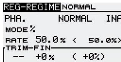
Cette fonction aussi doit d'abord être activée dans la ligne 'INA'. Marquez d'abord la fenêtre, réalisez le réglage avec la rubrique „CAP TOUCH“ et activez en actionnant "RTN". Ensuite dans la fenêtre apparaît 'MARCHE' ou 'INA'.
