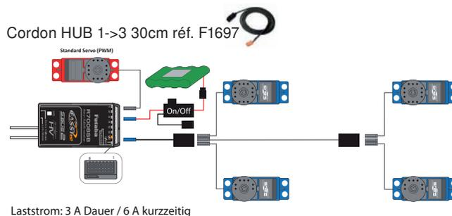
Un raccordement direct de l'accu au récepteur est susceptible de proposer un courant de 3A en permanence avec des pointes brèves à 6A.
