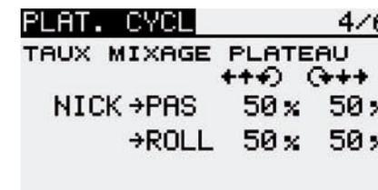
Dans le menu inférieur il est également possible de compenser l'incidence des différents éléments de timonerie.
