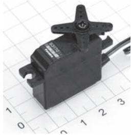
Variante haut voltage-S.BUS du servo numérique S3150 qui a fait ses preuves. Avec le couple sensationnel de 45 Ncm avec une "épaisseur" de seulement 10,8 mm. Le servo d'aile très robuste dispose d'un mécanisme à 5 étages avec 4 roues dentées métalliques, 2 roulements à billes protègent parfaitement la roue dentée de transmission contre les
