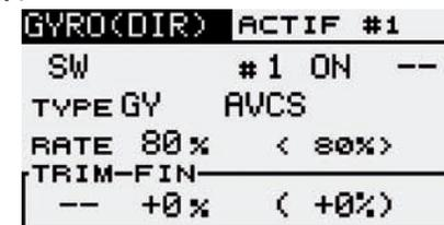
Cette fonction aussi doit d'abord être activée dans la ligne 'INA'. Marquez d'abord la fenêtre, réalisez le réglage avec la rubrique „CAP TOUCH“ et activez en actionnant "RTN". Ensuite dans la fenêtre apparaît 'MARCHE' ou 'INA'.
