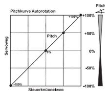
Exemple d'une courbe pour l'assiette de vol Autorotation'. Avec 'HOLD' on n'établit qu'une valeur inférieure des gaz qui coupe le moteur ou l'amène en position ralenti.
