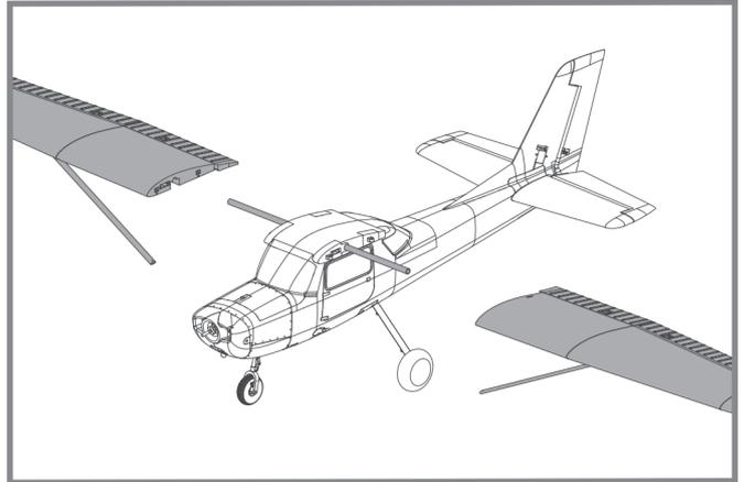
2. Fixez les mâts d'ailes au fuselage à l'aide des goupilles fournies.
