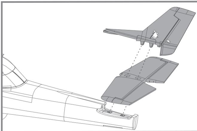
2. Fixez les empennages sur le fuselage avec les vis fournies.
