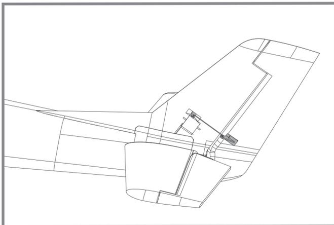
2. Mettez le servo de profondeur au neutre, puis branchez une des commandes fournies sur le palonnier de servo de profondeur et le guignol de la gouverne de profondeur.
