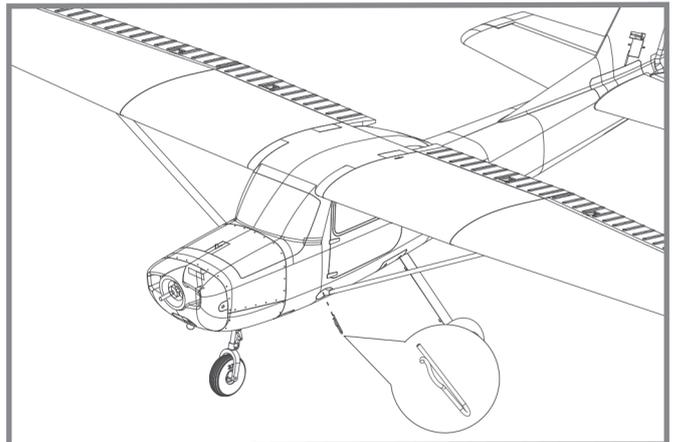
3. En posant le fuselage à l'envers, fixez les deux demi-ailes au fuselage avec les vis fournies.
