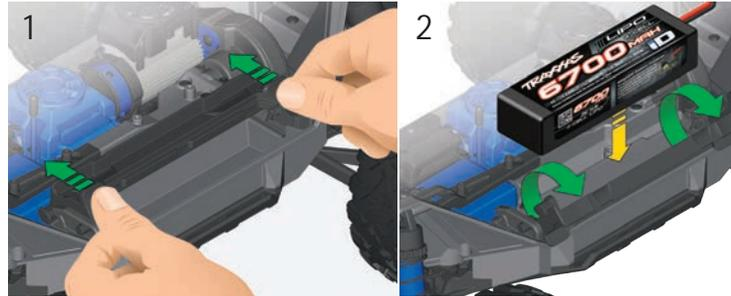
**Note :** Le compartiment pile peut accueillir la pile Traxxas 6700 mAh 4s (pièce #2890X). Lors de l'utilisation d'autres batteries LiPo, des blocs de mousse supplémentaires et des entretoises pour piles sont requis pour une fixation correcte (voir le graphique des piles).
