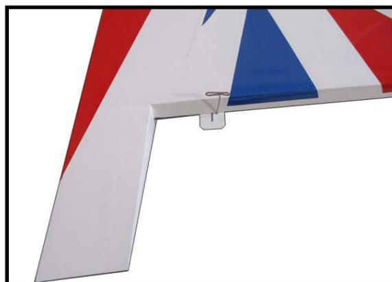
Faites glisser le panneau d'aile sur l'aileron jusqu'à ce qu'il n'y ait qu'un léger espace. La charnière est maintenant centrée sur le panneau d'aile et l'aileron. Retirez les goupilles en T et serrez l'aileron contre le panneau d'aile. Un espace de 1/64" ou moins doit être maintenu entre le panneau d'aile et l'aileron.
