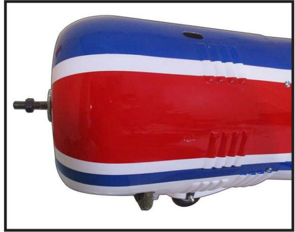
Installer le Muler et l'extension Muler sur le moteur et faites la découpe dans le capot pour le dégagement du muler. Connectez le Conduites de carburant et de pression vers le carburateur, le broyeur et la vanne de remplissage de carburant. Fixez le capot au fuselage à l'aide des vis à tête creuse M3x10 mm. Placer une petite longueur de tube de carburant en silicone sous la tête de la vis aide à réduire les vibrations.
