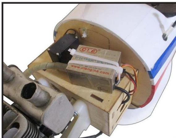
Connectez le module d'allumage à la ligne de détection du moteur. Fixez-le avec un clip de sécurité, un fil de sécurité, du ruban adhésif ou toute autre méthode. Assurez-vous que les fiches ne se détacheront pas sous l'effet des vibrations ou d'une légère tension.
