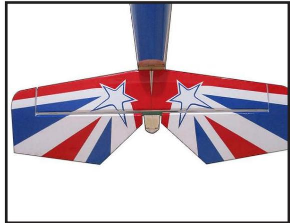
Avec le stabilisateur fermement maintenu en place, utilisez un stylo et tracez des lignes sur le stabilisateur à l'endroit où celui-ci et les côtés du fuselage se rencontrent. Faites ceci sur les deux côtés droit et gauche ainsi que sur le haut et le bas du stabilisateur.
