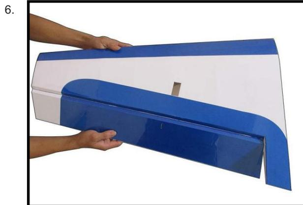
Retournez le panneau d'aile et dévissez l'aileron dans la direction opposée depuis le côté opposé. Appliquez de la colle C/A fine sur chaque charnière, en vous assurant que la colle C/A pénètre à la fois dans l'aileron et dans le panneau d'aile.
