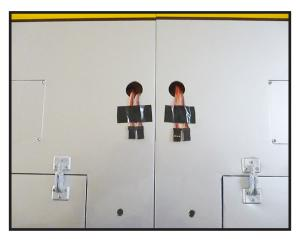
AILERON PUSHROD HORN INSTALLATION.
