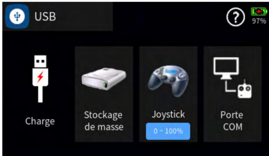
En appuyant sur le symbole "USB" dans le coin supérieur gauche, vous revenez à l'affichage d'origine, ce qui signifie que l'émetteur peut également être utilisé "normalement" pendant le processus de charge. Seul le cli-
