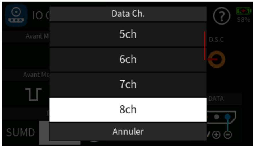
Si nécessaire, sélectionnez dans ce menu le nombre de canaux à émettre à partir du canal 1. Vous pouvez définir au minimum 4 et maximum 16 voies.
