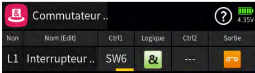
... par exemple, étant donné que la fonction d'arrêt du moteur activée avec SW6 a été désactivée, l'enregistrement d'un fichier de log commence et reste actif jusqu'à ce que l'interrupteur logique soit ouvert en réactivant la fonction d'arrêt du moteur.
