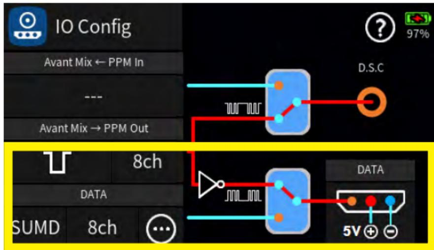
En appuyant sur le symbole de connexion en bas à droite, l'alimentation des appareils externes avec 5 V via la broche centrale du connecteur arrière de l'émetteur est allumée ou éteinte :
