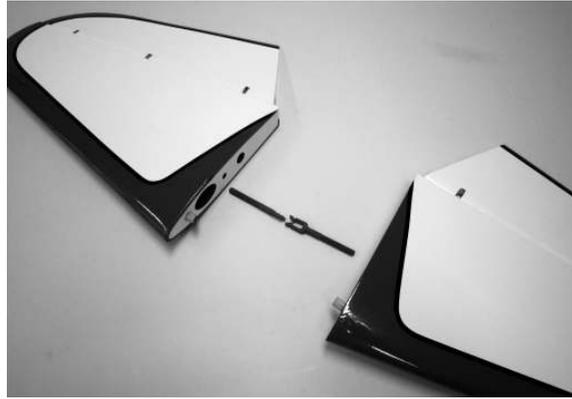
La profondeur d'implantation est correcte lorsque la distance entre les deux nervures d'emplanture correspond à la largeur du fuselage. Vérifiez cela avec des mesures et en montant le stabilisateur, avec le tube alu sur le fuselage.
