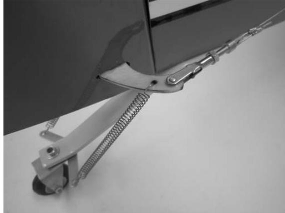
Comme décrit précédemment, montez les silent-blocs caoutchouc et les douilles sur les pattes du servo de commande de la direction et fixez-le servos sur la platine. Fixez les câbles aller-retour sur le palonnier du servo comme indiqué sur la photo. Tendre les câbles en vissant les chapes.
