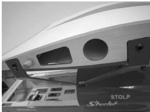
Pour les tétons de verrouillage des ailes, recherchez leur emplacement sur le dessus par tâtonnement et dégagez-les avec un fer à souder.
