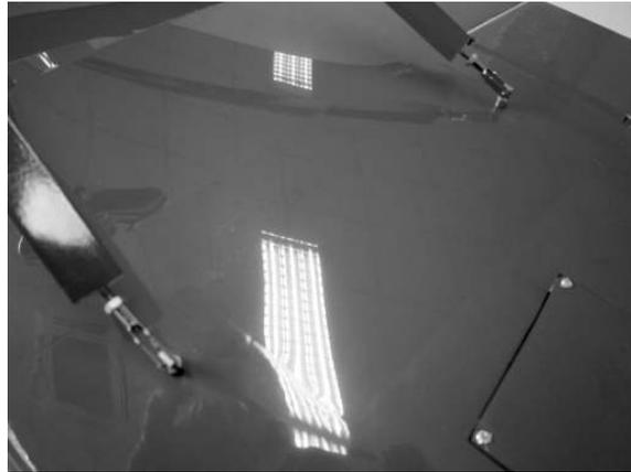
Pour un verrouillage fiable des deux ailes sur la partie centrale, vissez un téton de verrouillage dans la nervure d'emplanture de chaque aile. Mettez du frein-filets UHU sur le filetage et vissez le téton jusqu'en butée.
