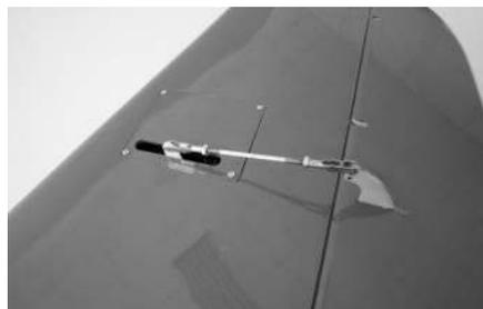
Pour le verrouillage des deux moitiés du stabilisateur sur le fuselage, vissez d'un côté la pièce femelle (fourche) du système de verrouillage et de l'autre, la pièce mâle.
