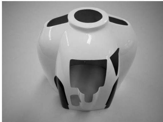
Le capot est fixé sur le fuselage avec trois vis. Montez le capot sur le fuselage de manière à obtenir un jeu de 1,5 mm entre capot et la flasque du cône. Reportez maintenant avec un feutre sur le fuselage, les bords du capot, à gauche, à droite et en haut. Percez les trous de fixation afin qu'ils tombent au milieu de l'épaisseur du couple moteur.
