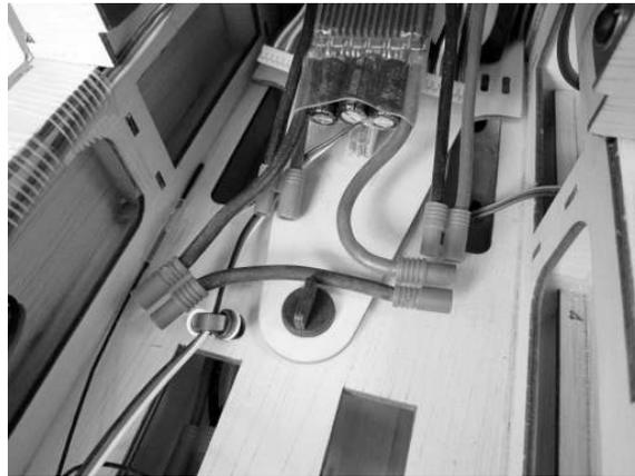
le récepteur est fixé sur la platine radio avec de la bande crochetée.
