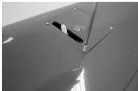
Faites les tringles de commande, les fixer sur les guignols et sur les palonniers des servos selon la photo ci-dessous. Lorsque les servos sont au neutre, les gouvernes doivent également être au neutre.
