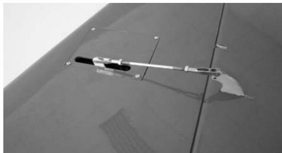
Lorsque les servos et les gouvernes sont au neutre, ajustez la longueur de la tringle et freinez chapes et écrous avec du frein-filets UHU.
