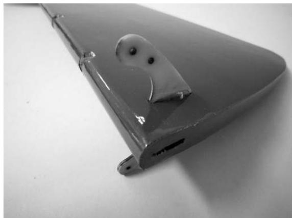
Avec la tige d'articulation, montez la gouverne de direction sur le fuselage.
