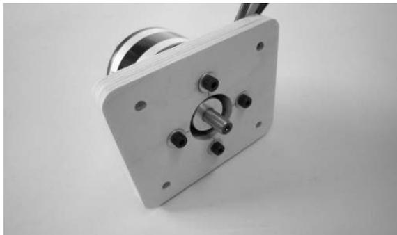
Comme indiqué sur la vue, montez le moteur avec son support sur le couple moteur du fuselage.
