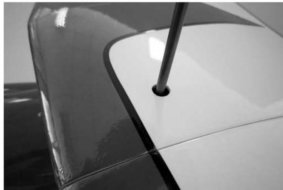
Montez les deux moitiés de stabilisateur avec le tube alu sur le fuselage, branchez les rallonges servos et rapprochez les deux moitiés jusqu'à ce que le système de verrouillage s'enclenche.
