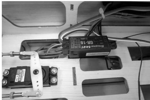
Les cordons servos passent sous la platine et remontent vers les sorties récepteur. L'interrupteur Marche/Arrêt PRX 5A peut être monté soit sur le flanc gauche du fuselage, soit sur le flanc droit.
