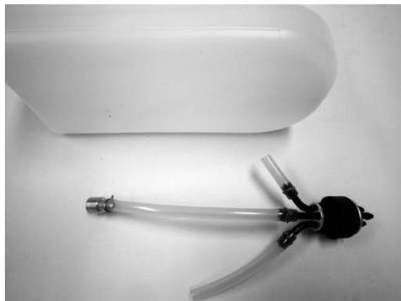
Montez maintenant le réservoir dans le fuselage de manière à ce que les trois durites ressortent par l'ouverture du couple moteur. Pour éviter que le réservoir ne se déplace en vol, les deux couples supports sont collés dans le fuselage, selon la photo ci-dessous.
