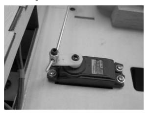
La tringle de commande des gaz est réglée de telle sorte que lorsque le servo est au neutre, le boisseau du carburateur est ouvert à moitié. La course du servo devra être réglée de telle sorte que lorsque le manche de commande et le trim sont complètement en bas, le moteur puisse se couper.
