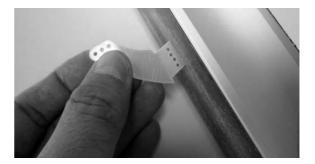
Comme on peut le voir sur les photos, masquez les surfaces autour des fentes des ailerons, des volets, de la direction et de la profondeur, qui recoivent les guignols GFK, remplissez la fente de colle avec une petite seringue et enfoncez le guignol jusqu'en butée.
