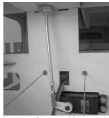
A l'aide de la bague d'arrêt, montez la jambe du train avant dans son bloc-support. Conformément à la photo, fixez les câbles "aller-retour". Comme pour la gouverne de direction, veillez à ce que la roue avant soit au neutre lorsque le servo est également au neutre, pour qu'au roulage, le modèle ait une trajectoire rectiligne.
