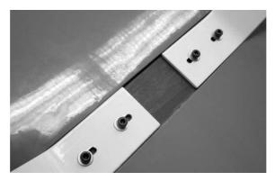
Pour le montage des deux roues principales et de leur carénage, il faut percer/limer un trou à 15 mm du bas de chacun des carénages. Attention, il faut un carénage gauche et un carénage droit. Pour renforcer le carénage, collez le renfort CTP joint à l'intérieur de chacun des carénages. Veillez à ce que les perçages du renfort et du carénage coïncident. Pour cela, vous pouvez vous servir de l'axe de la roue.
