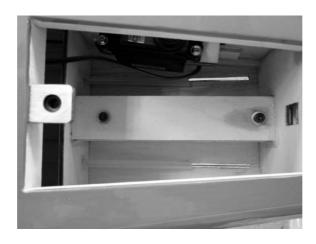
Le stabilisateur est fixé par le dessous sur le fuselage avec 3 vis CHc.
