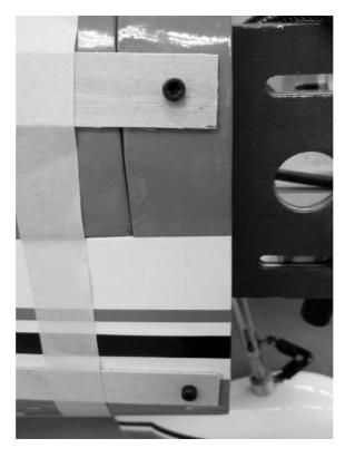
Devissez les vis CHc, montez le capot de manière à le faire passer sous les languettes et que le jeu entre le plateau et le capot soit de 1,5 - 2 mm. Dans cette position, reportez les quatre trous de fixation sur le capot
