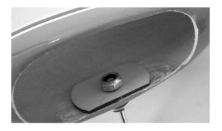
Après séchage de la colle, montez les axes avec les roues et les bagues d'arrêt sur la lame du train d'atterrissage.
