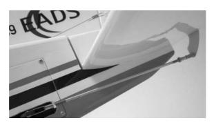
Fixez maintenat les deux lames du train proncipal, avec respectivement deux vis CHC sur le fond du fuselage.
