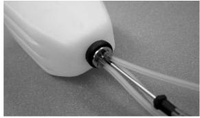
La durite du plongeur est branché sur le carburateur, celle du trop-plein est dirigée vers le bas. La durite de remplissage peut être passée, par après, à travers une ouverture du capot moteur, vers l'extérieur. L'extrémité de celle-ci sera rebouchée, après le plein.
