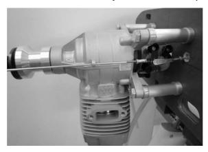
Montez la tringle de commande des gaz sur le palonnier du servo de commande des gaz en veillant à ce que le raccord puisse tourner sur le palonnier sans jeu apparent. Longueur du bras du palonnier env. 13mm.
