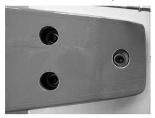
Ne serrez les vis que jusqu'à ce que le stabilisateur et la dérive reposent correctement sur le fuselage, ne serrez pas trop fort!
